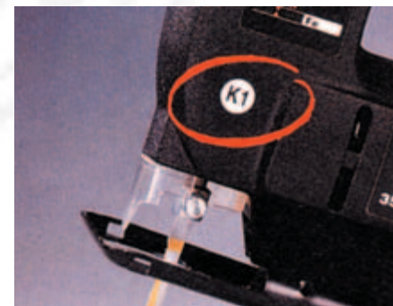
Bild 8-1: Kennzeichnung der Anwendungskategorie am Betriebsmittel, hier K1
