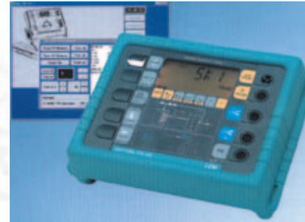
Bild 5-9: Prüfgerät für EuP geeignet. Gut-/Schlecht-Anzeige durch Signalleuchten, keine Messwertanzeige. Diverse Steckvorrichtungen
