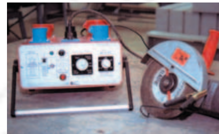
Bild 5-9: Prüfgerät für EuP geeignet. Gut-/Schlecht-Anzeige durch Signalleuchten, keine Messwertanzeige. Diverse Steckvorrichtungen
