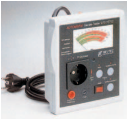
Bild 5-5: Prüf-/Netzsteckdose, je nach Prüfabschnitt. Grenzwerte sind auf der Skala farbig markiert
