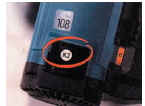
Bild 8-2: Kennzeichnung der Anwendungskategorie am Betriebsmittel, hier K2
