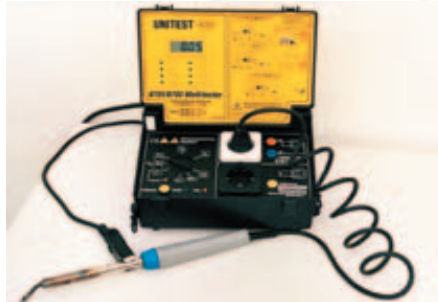
Bild 5-3: Prüf-/Netzsteckdose, je nach Prüfabschnitt. Alle relevanten Messungen sind möglich. Mit Zusatzmodulen sind Datenübertragung, Speicherung, Ausdruck und Drehstrom-Geräteanschluss möglich
