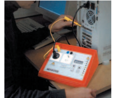
Bild 5-11: Zur Prüfung von ein- und dreiphasigen Geräten geeignet, inklusive Differenzstrommessung und Datenübertragung. Mit unterschiedlichen Ausstattungen erhältlich
