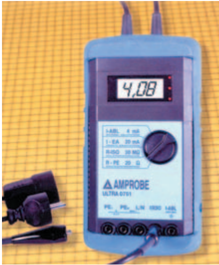
Bild 5-5: Prüf-/Netzsteckdose, je nach Prüfabschnitt. Grenzwerte sind auf der Skala farbig markiert
